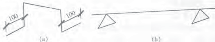
图 6-2-1 钢筋撑脚图
