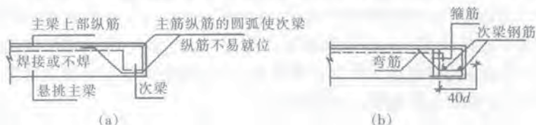
图 7-1-22 梁端有集中荷载配筋
