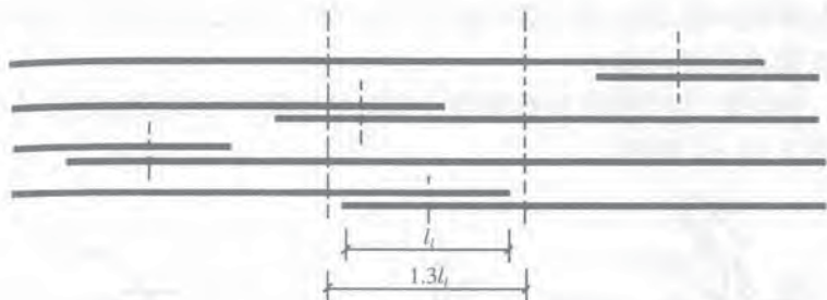
图 2-1-2 同一连接区内的纵向受拉钢筋绑扎搭接接头
