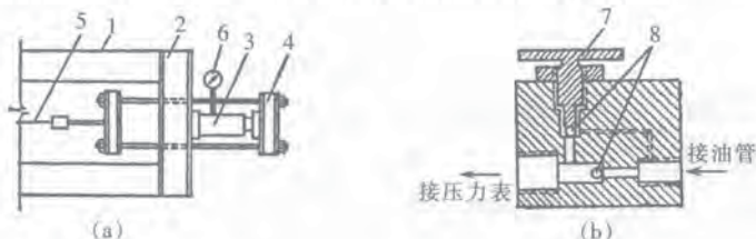
图 5-1-11 用液压千斤顶控制应力
