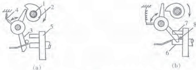
图 5-2-14 喂料机构的工作简图
